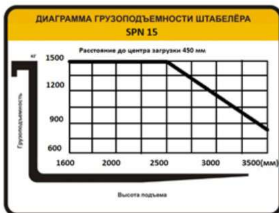
Рисунок. 4. Диаграмма грузоподъемности штабелера.
