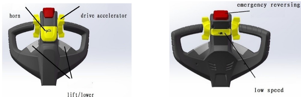
Рис.4 Horn – звуковой сигнал; drive accelerator – высокая скорость; lift/lower – кнопки управления «вверх»/«вниз»; drive acceleration – высокая скорость; Emergency reversing – кнопка аварийного обратного движения; low speed – медленная скорость.
